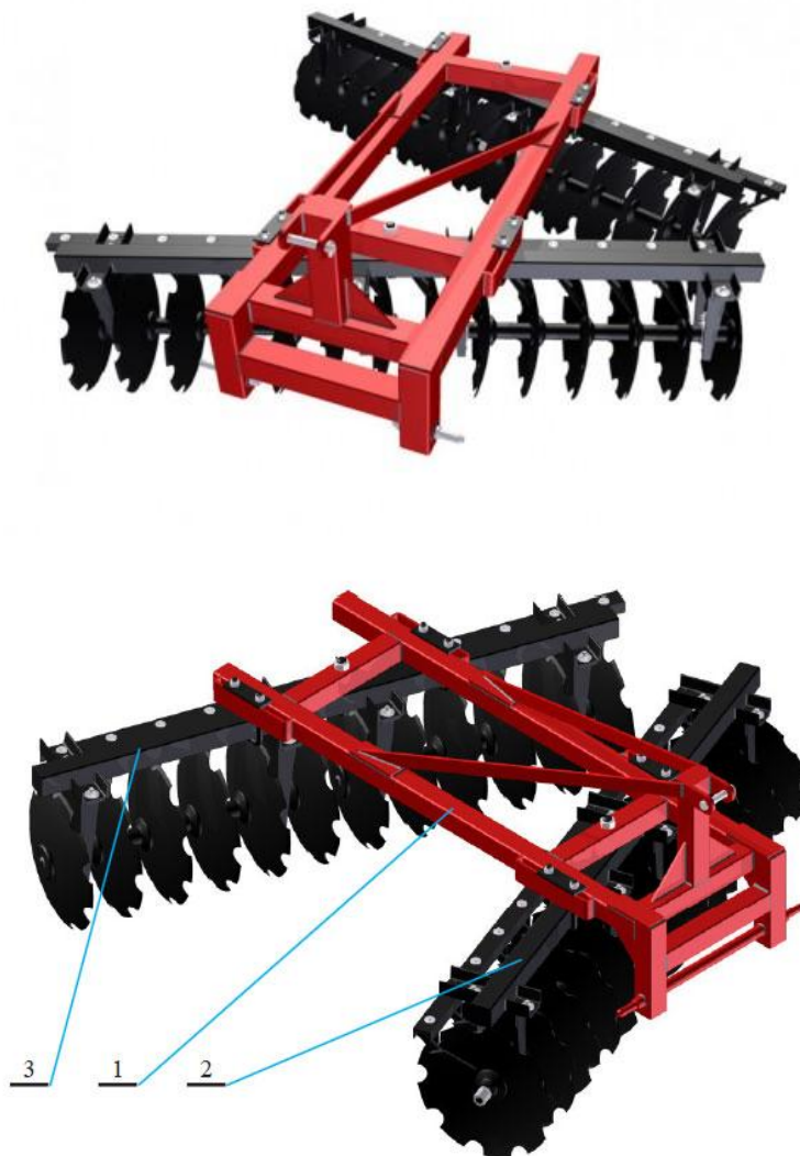
Slika 3.2.16. Osnovni delovi lakih tanjirača
